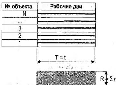
Рис 2. Линейный график строительства  $N$  одинаковых объектов параллельным методом
