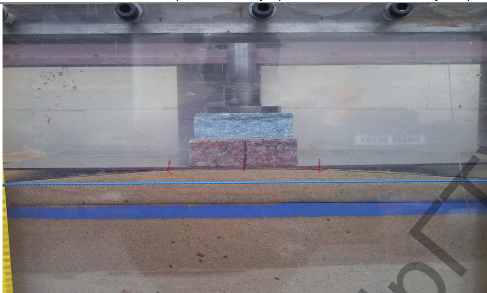
Рис. 5. Общий вид основания в форме трапеции до нагружения
