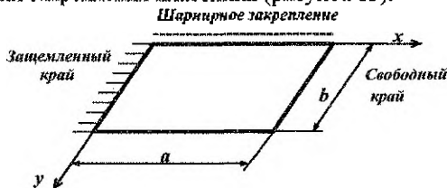
Рисунок 13 - Варианты закрепления граней пластинки
