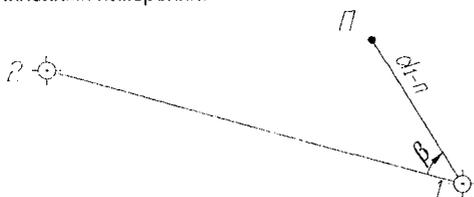
Рисунок 2.1 – Способ полярных координат
