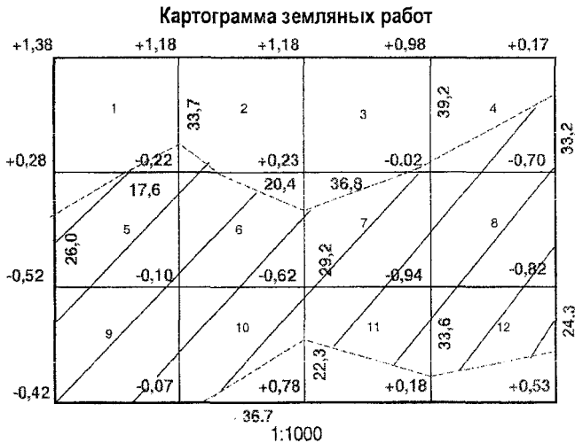
Рисунок 1.7 – Пример оформления картограммы земляных работ
