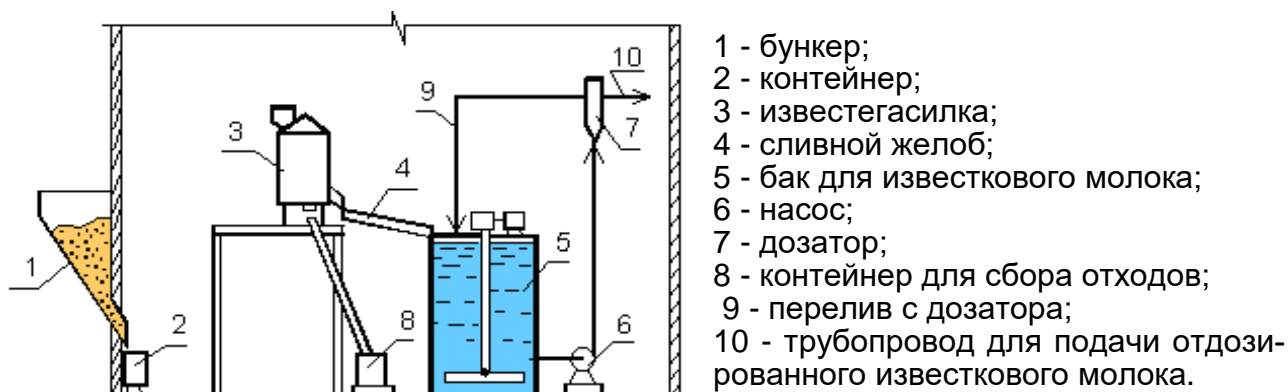
Рисунок 2.3 – Схема известкового хозяйства с использованием комовой извести при сухом хранении
