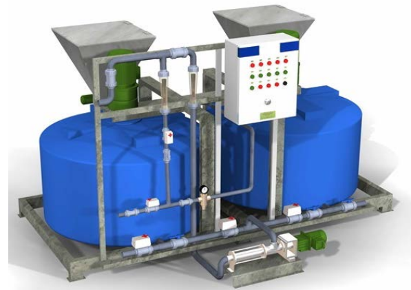
Рисунок 2.9 – Станция приготовления флокулянта производства АО «ДАКТ-Инжиниринг»[9]
