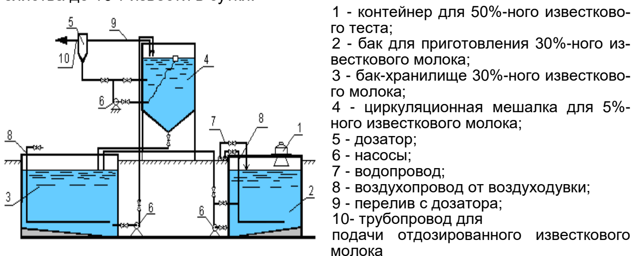
Рисунок 2.4 – Схема известкового хозяйства с использованием привозного известкового теста
