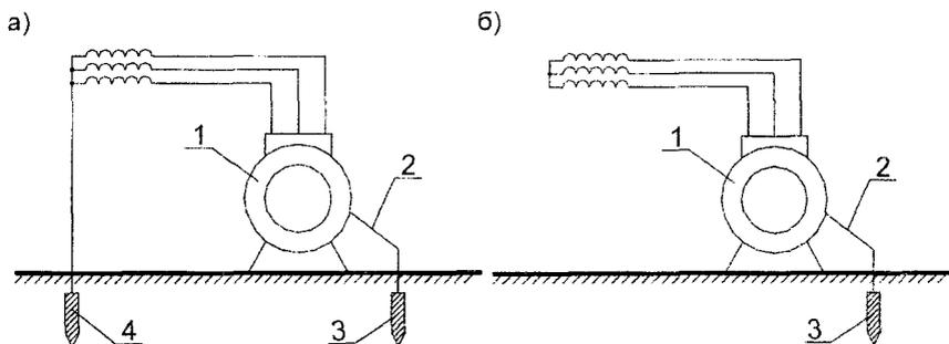
Рисунок 6.1. Принципиальные схемы защитного заземления
