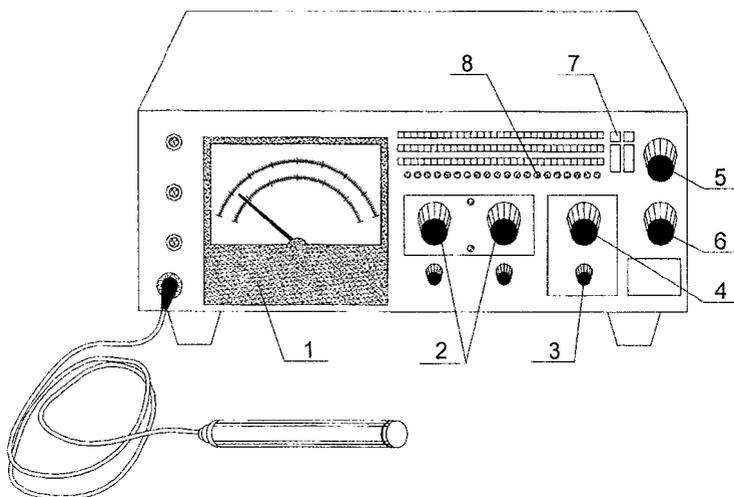
**Рисунок 1.3 Измеритель шума и вибрации ВШВ-003**
