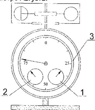
Рисунок 5.2. Анемометр чашечный
