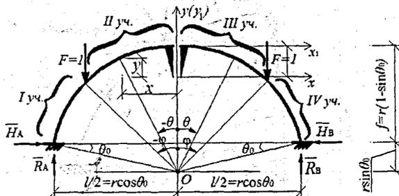
Рисунок 4 – Единичное состояние для определения вертикального перемещения
