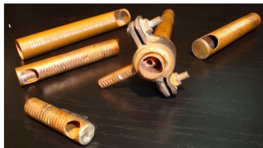
Рис. 4. Циліндричні насадки з ортогональним бічним входом: а – схема; б – загальний вигляд (в центрі фрагмент РТ зі змонтованою в ньому насадкою)
