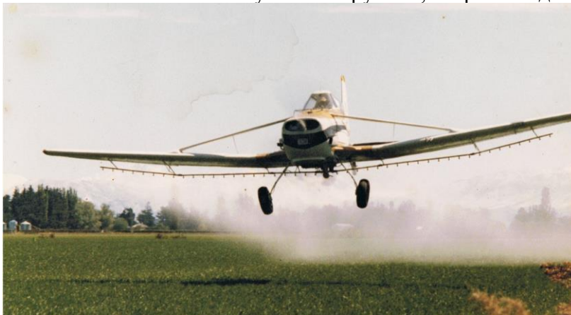
Рис. 1. Напірний розподільний трубопровід у сільськогосподарській авіації (Cessna 188 AGWagon, Нова Зеландія; світлина взято з сайту: https://commons.wikimedia.org/wiki/File:Cessna188AGWagonZKCSE.jpg )
