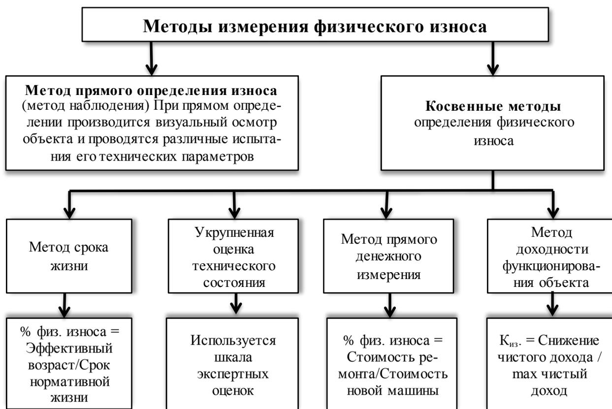
Рис. 2.2. Методы измерения физического износа
