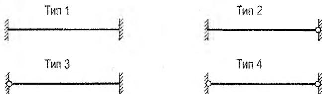
Рисунок А.1 – Типы стержней
