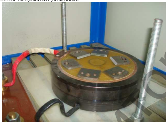
Рис. 1. Установка ножей на плоский индуктор
