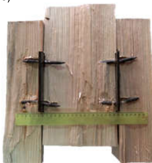
Рисунок 2 – Характер разрушения образцов
