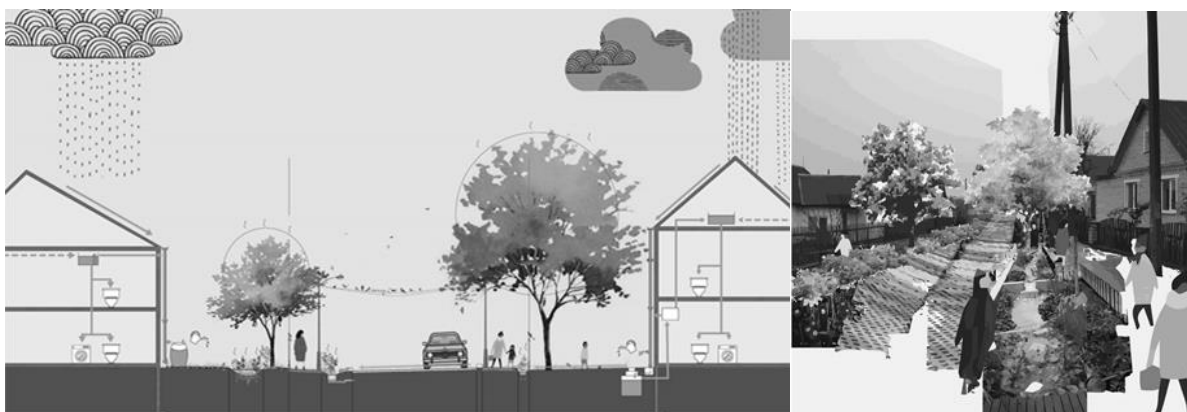
Рисунок 3 – Управление ливневыми осадками в районе усадебной застройки в Новогрудке: создание на придомовой территории дождевого сада для сбора воды с крыши зданий, биоретанционных каналов вдоль проезжей части (дипломный проект Цурковской А. А.)
