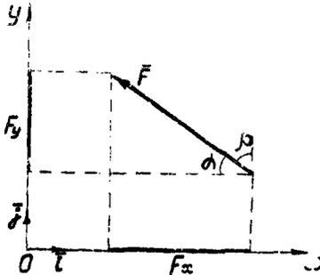
Проекцией силы на ось называется скалярная величина, равная произведению модуля силы на косинус острого угла между вектором силы и осью, взятому с соответствующим знаком.
