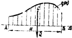
Равнодействующая такой нагрузки  $\bar{Q}$  по модулю равна площади криволинейной трапеции и приложена в центре тяжести  $C$  этой трапеции.
