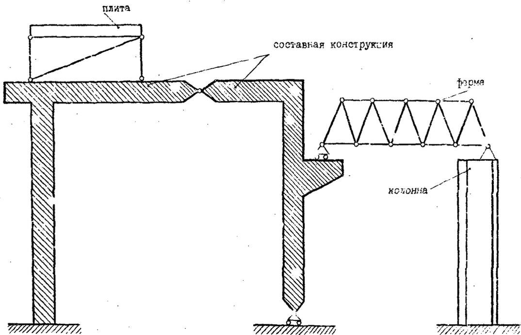
ис. I. Общая схема каркаса промышленного здания.
