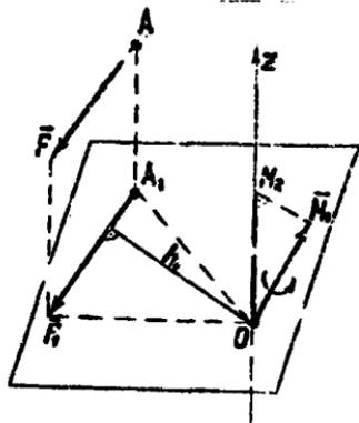
Моментом силы относительно оси в пространстве называется скалярная величина  $M_z$ , равная моменту проекции силы на плоскость, перпендикулярную оси, относительно той же пересечения оси с плоскостью.
