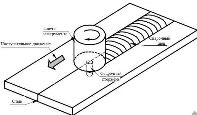
Рис. 1. Схема процесса сварки трением с перемешиванием
