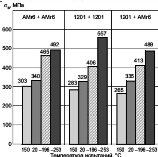
**Рис. 4.** Механические свойства соединений, полученных фрикционной сваркой (приведены минимальные значения, испытывали 5 образцов толщиной 4,0 мм)
