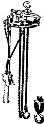
Рис. 8.4. Таль с комбинированным приводом механизированным или ручным с помощью цепи и редуктора
