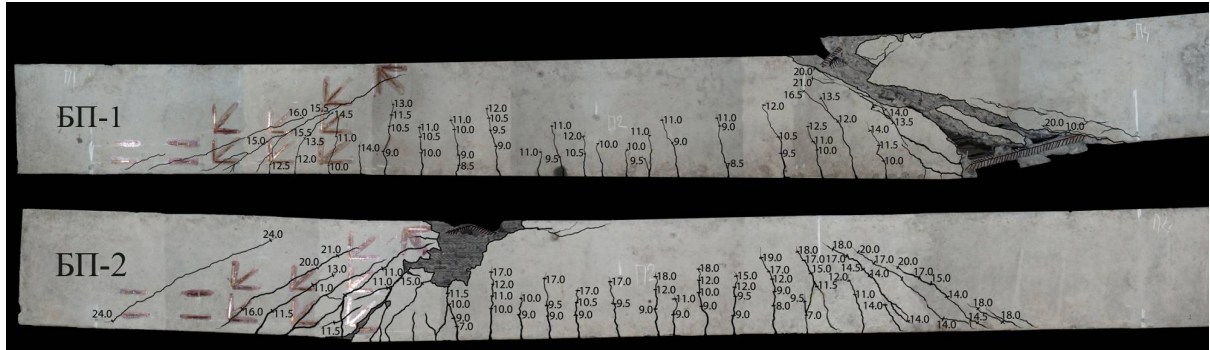
Рисунок 2 – Трещинообразование и разрушение опытных балок серии БП
