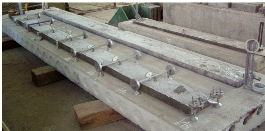
Рисунок 2 – Общий вид монолитных плит П – п – Х, П – п – ХI, (слева – направо)
