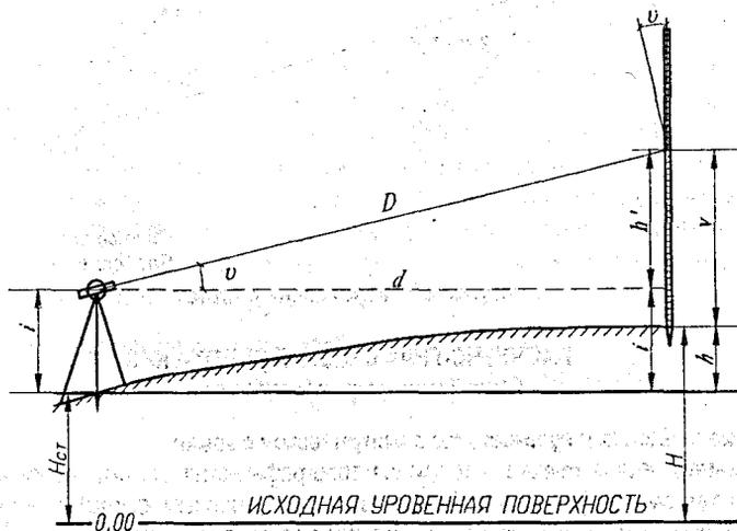
Рисунок 3.1 – Схема тригонометрического нивелирования
