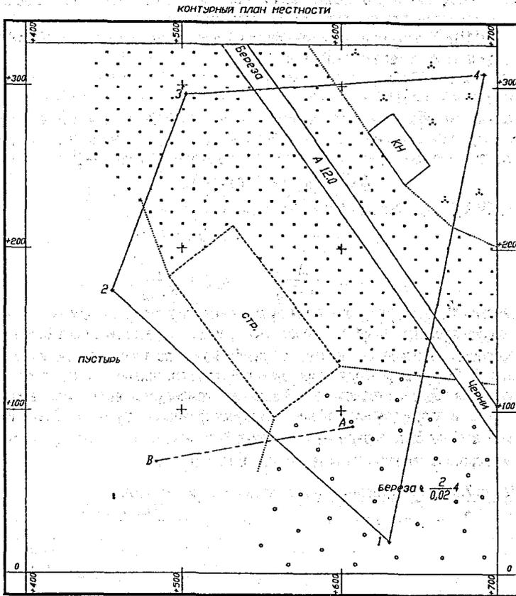
Рисунок 2.3 – План теодолитной съемки с указанной на нем проектной осью АВ
