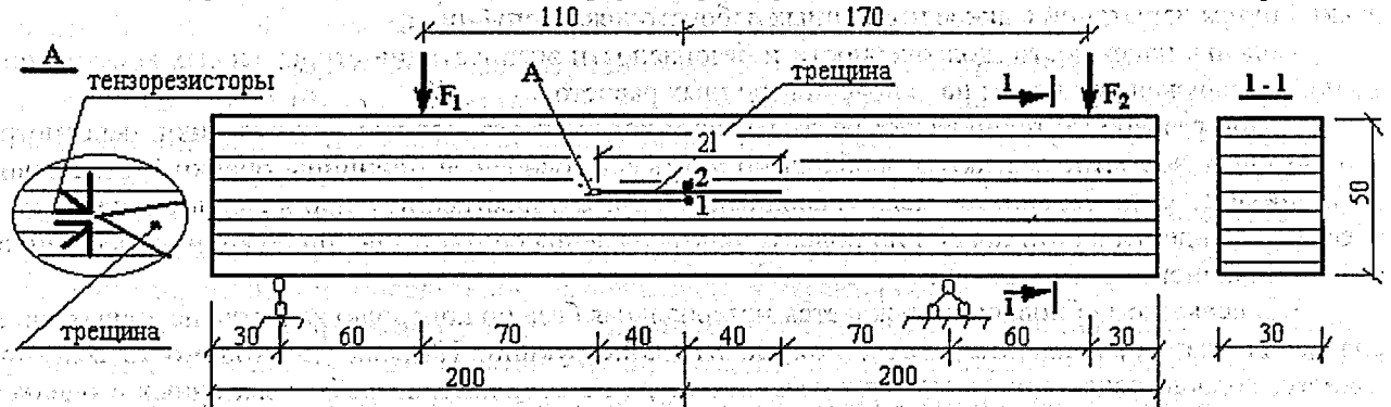
Рисунок 1— Схема балочного образца с трещиной, расположенной по нейтральной оси
