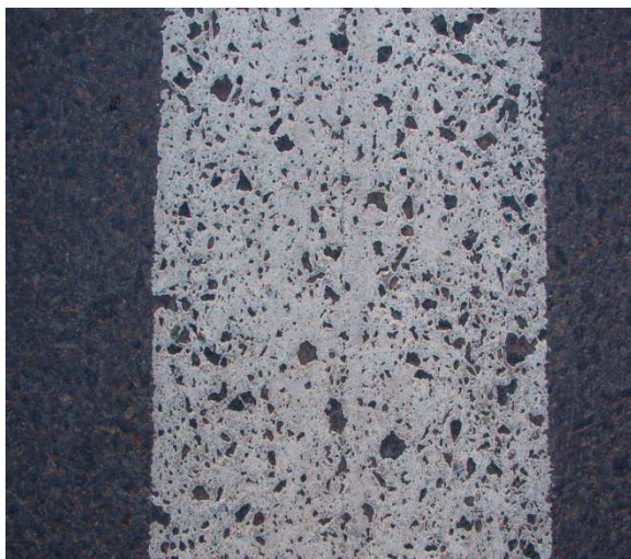
Рис. 3. Фотография разметки (полимер №1) после 4 месяцев натуральных испытаний (износ 15–20%)
