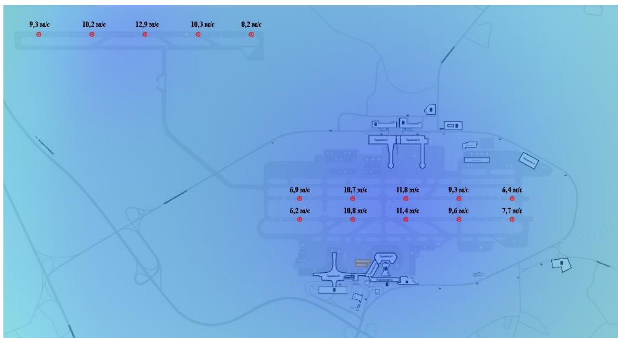
Рисунок 2 – Динамика возмущений воздушной среды в пределах взлетно-посадочных полос аэропорта Шереметьево (июль 2020 г.)
