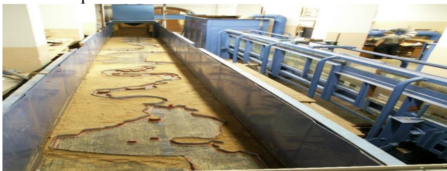
Рисунок 4 – Лабораторная установка для изучения режима течений в водохранилищах
