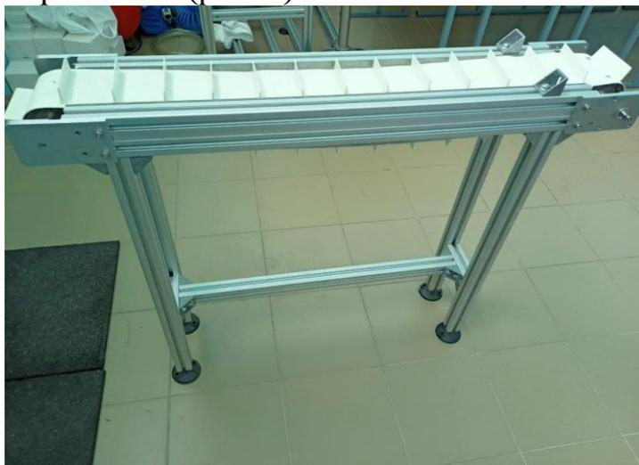
Рисунок 4 – Шаговый конвейер с серводвигателем
