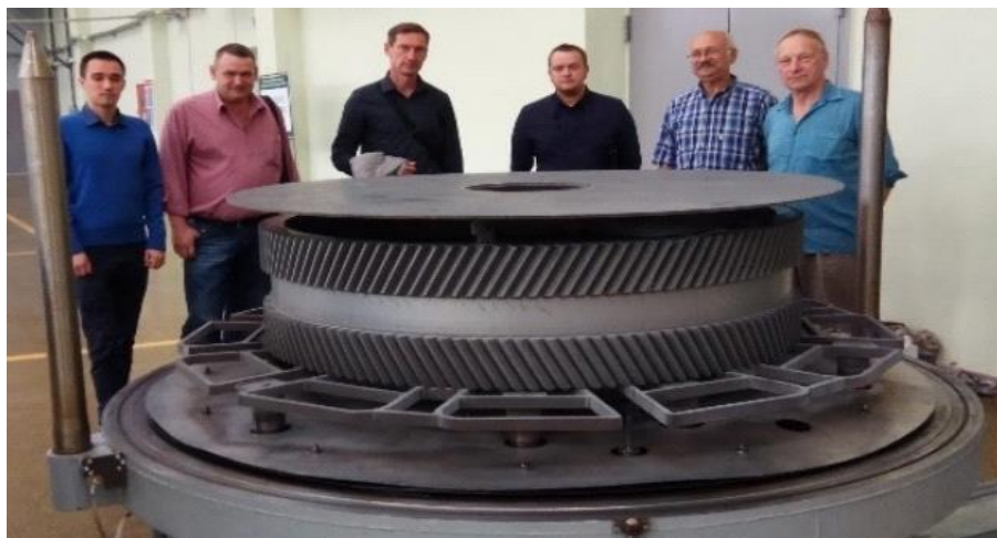
Рисунок 1 - Вал-шестерня и колесо после проведения ИПА в установках с рабочим пространством высотой 3000 мм (а) и диаметром 2 200 мм (б)
