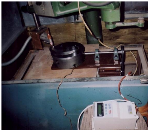
Рисунок 2 – Фрагмент экспериментальной установки для поверхностного плазменно-дугового упрочнения стальных изделий
