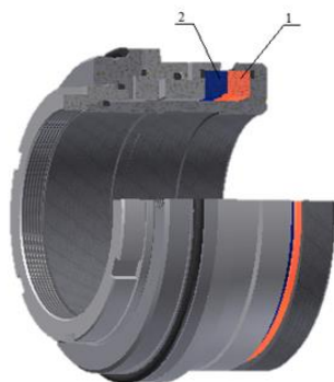
1 – кольцо неподвижное; 2 – кольцо вращающееся Рисунок 2. – 3D модель торцового уплотнения
