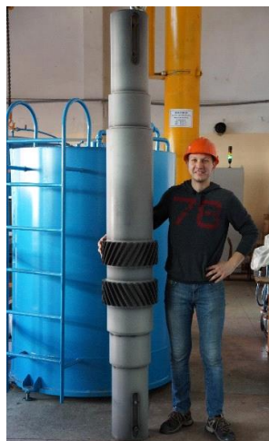
Рисунок 1 - Вал-шестерня и колесо после проведения ИПА в установках с рабочим пространством высотой 3000 мм (а) и диаметром 2 200 мм (б)
