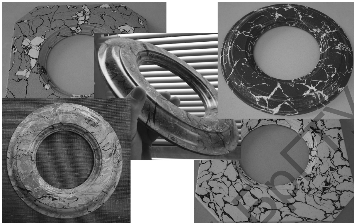
Рисунок 7 – Детали, выполненные в технике Scagliola по новому технологическому комплексу
