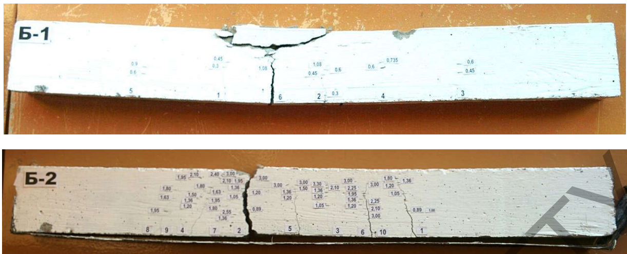
Рисунок 2 – Характер разрушения экспериментальных балок
