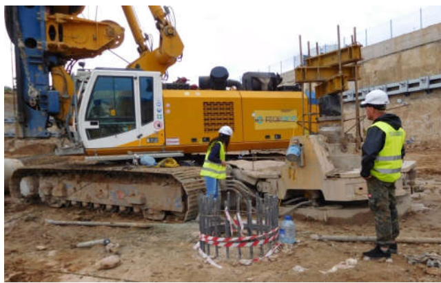
Рисунок 5 – Общий вид испытания грунтов по принципу «труба в трубе» с передачей гидродомкратом нагрузки на вдавливаемый штамп и выдергиваемую обсадку
