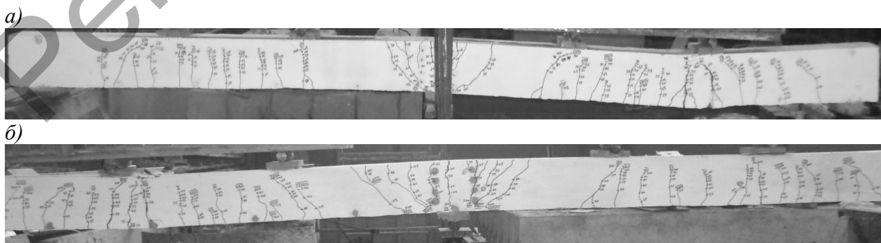
Рисунок 5 – Балка Б3(а) и Б1Э(б) после испытания
