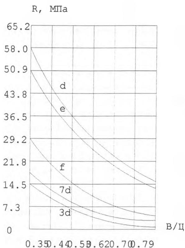
Рис.3 График зависимости прочности бетона от водоцементного отношения при температуре выдерживания : 1 день при  $t=+21^{\circ}\text{C}$ ; 27 дней при  $t=-4^{\circ}\text{C}$ ; затем опять при  $t=+21^{\circ}\text{C}$ .
