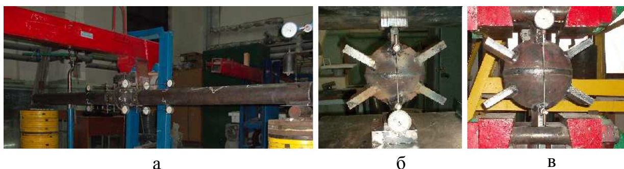
Рисунок 4. – Экспериментальное определение вращательной жёсткости (а), жёсткости при сжатии (б) и растяжении (в) узлов в виде стального полого шара
