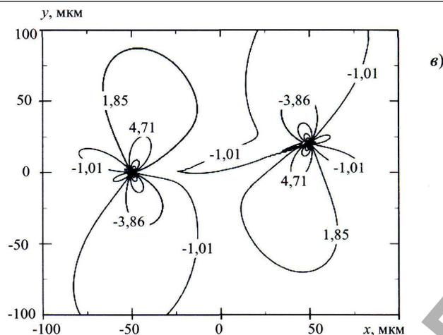
Рис. 6. Распределение напряжений у тонкого линзовидного двойника при наличии включения на оси x (МПа): а)  $\sigma_{xx}^{tw}(x, y)$ ; б)  $\sigma_{yy}^{tw}(x, y)$ ; в)  $\sigma_{xy}^{tw}(x, y)$
