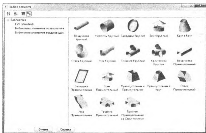
Рисунок 2 – Библиотека стандартных элементов в редакторе Техтран
