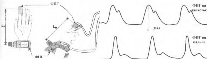
Рисунок 3 – Места крепления ФПГ-датчиков на запястье и пальце, а также ФПГ-сигналы с запястья и пальца
