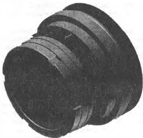
Рисунок 1 – 3D модель торцового уплотнения типа УТН-120С
