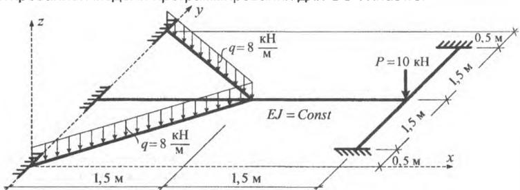
Рисунок 2 – Расчетная схема системы перекрестных балок
