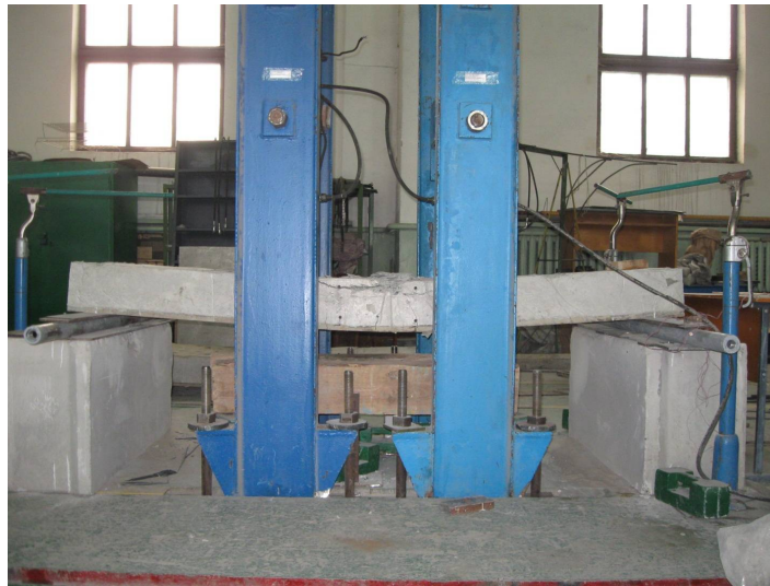
Рисунок 4 – Общий вид испытания плит на изгиб
