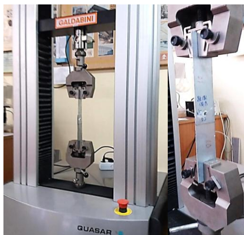
Рисунок 3 – Испытательная установка, образец для испытания на срез
