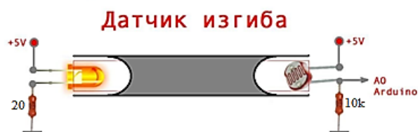
Рисунок 3 – Принцип работы датчика изгиба
