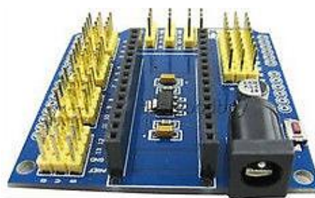
Рисунок 5 — Схема расширения к плате Arduino
