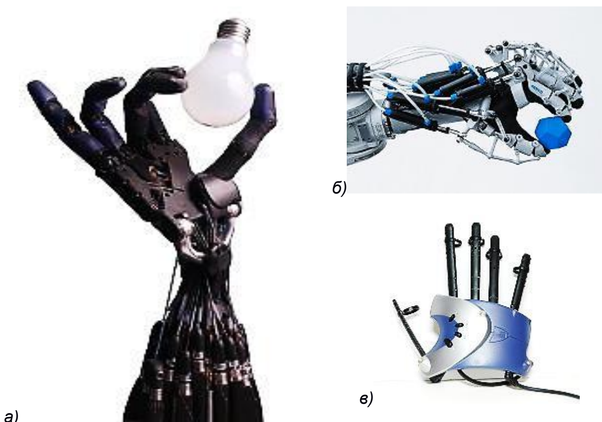
Рисунок 1 – Манипуляторы Shadow Dexterous Hand (а), и ExoHand (б), выполняющие удержание объекта, а также Перчатка для захвата движений Essential Reality Glove (в)
