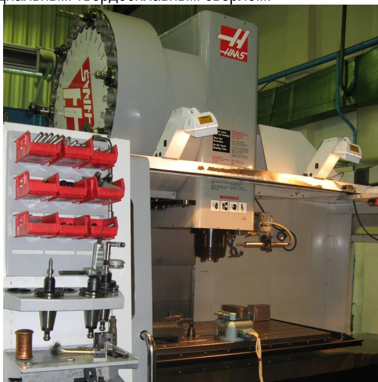
Рисунок 2 –Динамометр СУРП-600 на столе станка Haas VF-6
