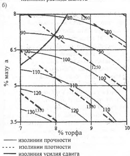
Рисунок 4. Номограммы определения расхода добавок при  $P_{сдв.} = 9,4$  кг (а), комплексного анализа влияния добавок на плотность и прочность при расходе шамота 1 % (б).
