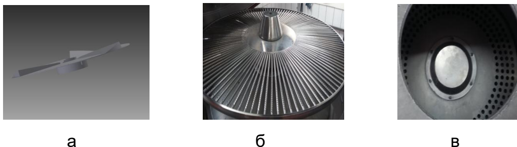
Рисунок 2 – Конструкции роторов а) для шерстных с/п; б) для слизистых с/п; в) для мякотных с/п
