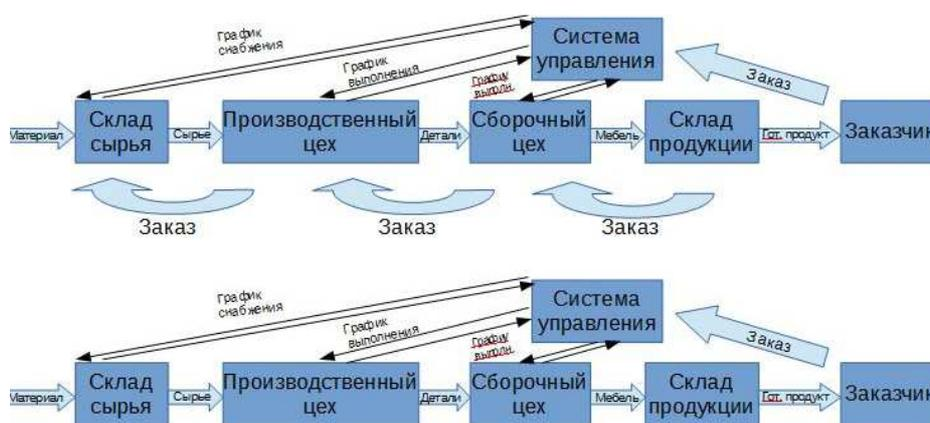
**Рисунок 2 – Логистическая схема. Тянущий и толкающий тип**
