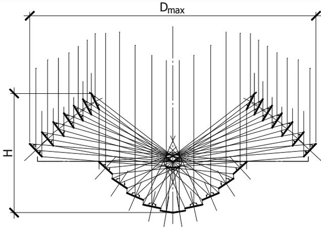
Рис. 2. Концентратор в виде расщепленного параболоида
