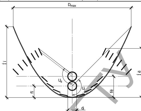
Рис. 1. Совмещение двух концентраторов и их основные размеры
