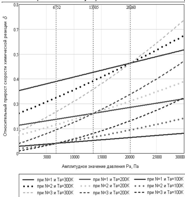
Рис. 4. Влияние амплитудного значения давления на увеличение скорости химических реакций 1-го, 2-го и 3-го порядка при  $T_{cp} = 1500 \text{ K}$  и  $T_a = 100 \text{ K}$ ,  $T_a = 200 \text{ K}$ ,  $T_a = 300 \text{ K}$
