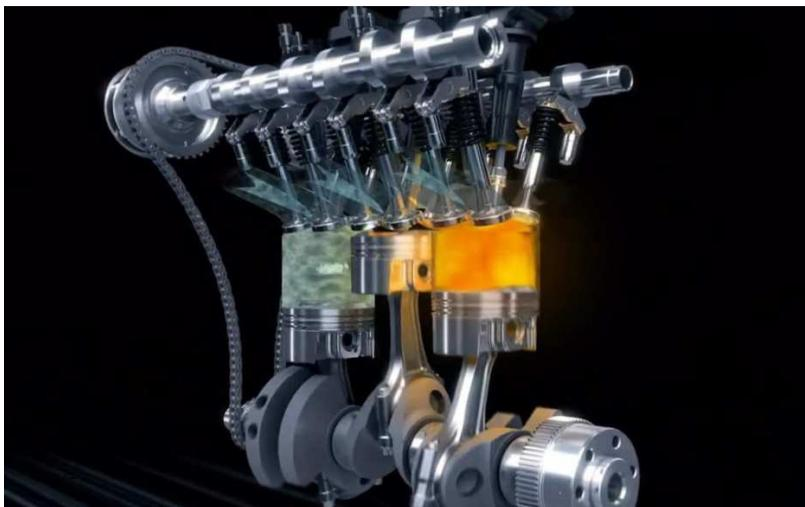
Рисунок 1. Фрагмент видеофильма, демонстрирующего работу автомобильного двигателя
