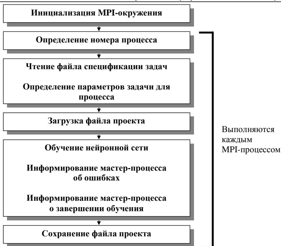
Рис. 1. Последовательность этапов обучения нейронных сетей в параллельном режиме.
