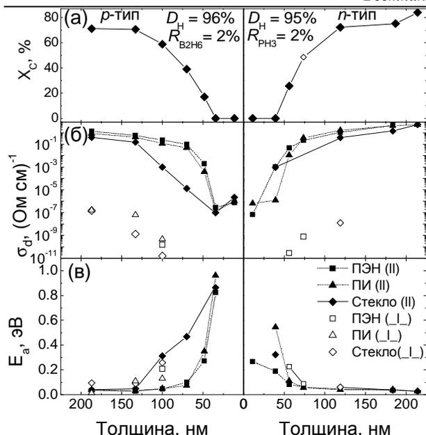
Рис. 3. Кристалличность (а), темновая проводимость (б) и энергия активации (в) кремниевых пленок с примесью бора (слева) и фосфора (справа) в зависимости от толщины. В (б) и (в) сплошные символы относятся к значениям  $\sigma_d$  и  $E_a$ , измеренным в планарной геометрии, а пустые значки к  $\sigma_d$  and  $E_a$  в перпендикулярном направлении
