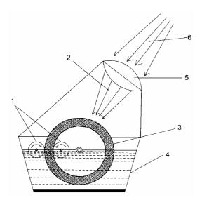
Устройство относится к теплохимическим двигателям, в которых получение механической (электрической) энергии обусловлено процессом осмоса. Причем процесс осмоса в них возобновляется путем возврата смешанного или отработанного раствора со средней концентрацией соли в исходное положение за счет обратного осмоса (самого экономичного способа обессоливания растворов, известного в технике).
