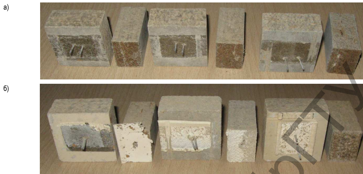
а – серия Г; б – серия Д Рис. 5. Характер разрушения образцов клеемеханических соединений ЦСП
