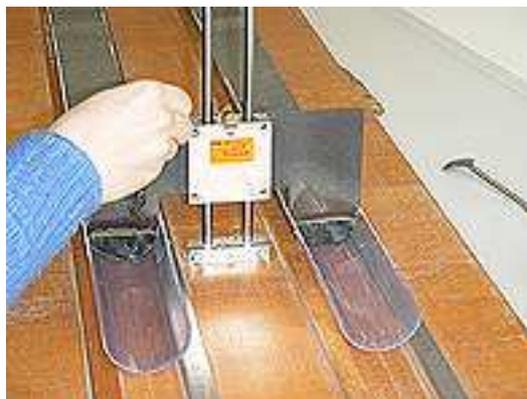
Рис. 3 – Разрезание пробы на тонкие слои толщиной 1 см.
