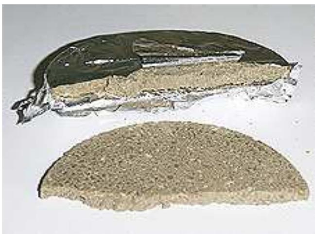
Рис. 4 – Спрессованная пластина в алюминиевой фольге.
