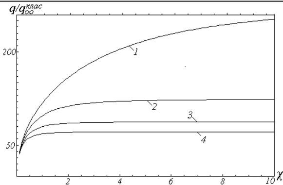
Рис. 5 – Зависимость безразмерного коэффициента затухания  $q/q_{\infty}^{class}$  от безразмерной частоты  $\chi$  при разных значениях параметра  $n_*$ : 1 -  $n_* = 0.1$ ; 2 -  $n_* = 0.5$ ; 3 -  $n_* = 1$ ; 4 -  $n_* = 1.5$ .
