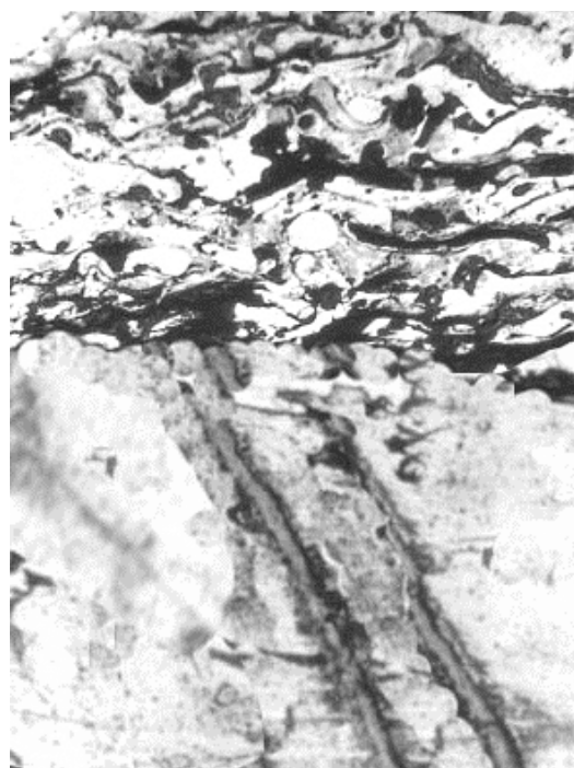
Рис. 6. Структура покрытия на основе ИСХ28Н2 после плазменного напыления: а) при грануляции 80..120 мкм (x 300); б) при грануляции 40..80 мкм
