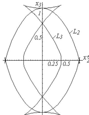
Рисунок 6 - Волновые фронты  $L_{2,3}$  квазипоперечных волн в плоскости  $x'_1 = 0, \times 10^3 (м)$ .
