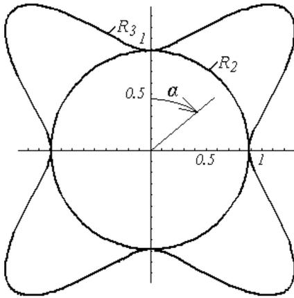
Рисунок 3 - Кривые обратных скоростей  $R_{2,3}$  в плоскости  $x_1 = 0, \times 10^{-3} (м/с)^{-1}$ .
