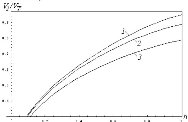
Рисунок 5 – Зависимость безразмерной скорости распространения поверхности разрыва  $V_2/V_T$  от параметра  $n$  при разных значениях параметра  $m$ : 1 -  $m=1$ ; 2 -  $m=5$ ; 3 -  $m=20$ .
