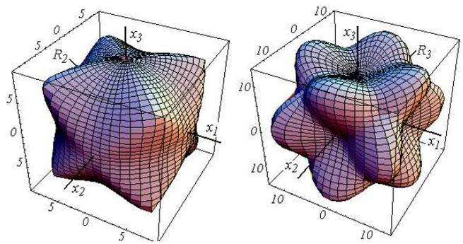
Рисунок 1 - Поверхности обратных скоростей  $R_{2,3}$ ,  $\times 10^{-3}$  (м/с)<sup>-1</sup>.
