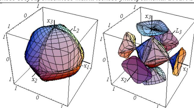
Рисунок 2 - Волновые поверхности  $L_{2,3}$  квазипоперечных волн, км/с.
