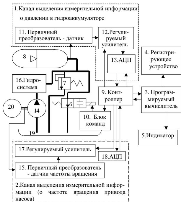
Рисунок 1 – Схема микропроцессорной части аппаратно-программных средств.
